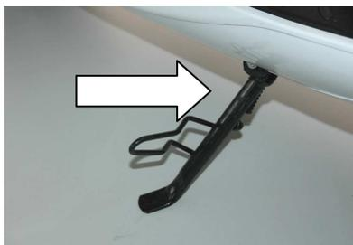
Beim Scooter ES01 sind ein Haupt- und ein Seitenständer vorhanden. Bei ausgeklapptem Seitenständer kann der Scooter nicht in Betrieb genommen werden (Sicherheitsschaltung).
