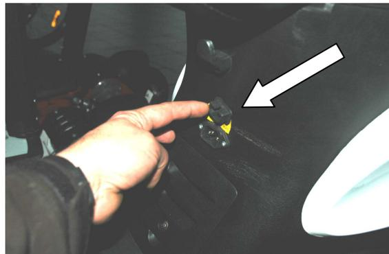
Ladegerät am Stromnetz angeschlossen > Rote Kontrolllampe leuchtet, Ladegerät ist bereit.
