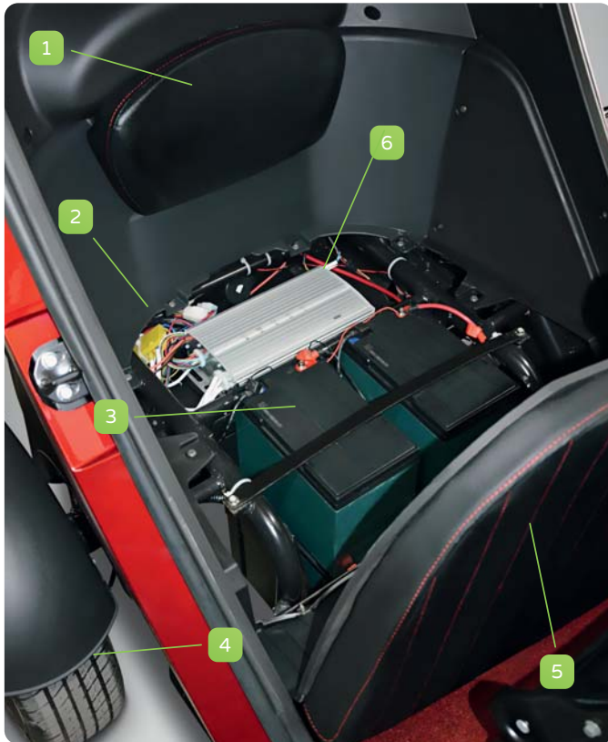
Das Steuergerät
