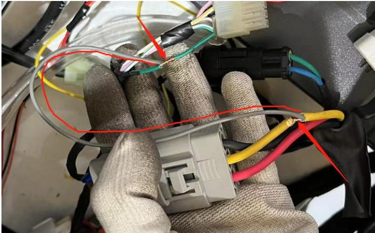
Schritt 5: Anschließend testen Sie die Ladestation, um sicherzustellen, dass sie ordnungsgemäß laden kann. Falls alles normal verläuft, wickeln Sie die beiden Punkte der parallelen Verbindung mit PVC-Klebeband um und isolieren sie ordnungsgemäß. Nachdem Sie die Kabelbündel geordnet haben, setzen Sie sie wieder in die Aufbewahrungsbox ein.
