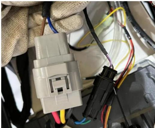
Schritt 3: Wenn bei den entsprechenden 3 löchrigen Plug-In nur zwei Kabel am Ende des Kabelbaums vorhanden sind und die Mitte leer, wie in der Abbildung unten gezeigt, fahren Sie mit den folgenden Schrittfort.
