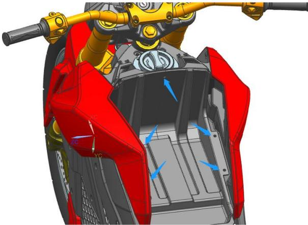
Schritt 2: Entfernen Sie die Aufbewahrungsbox und suchen Sie den Steckverbinder, der zur Schnellladebuchse passt:
