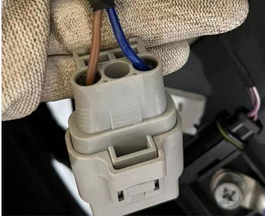
Schritt 4: Wie in der Abbildung gezeigt, verbinden Sie an der anderen Seite des 3 löchrigen Steckers eine zusätzliche Leitung mit der mittleren gelb-grünen Leitung und verbinden sie mit der grünen Leitung im gesamten Fahrzeugkabelbaum.
