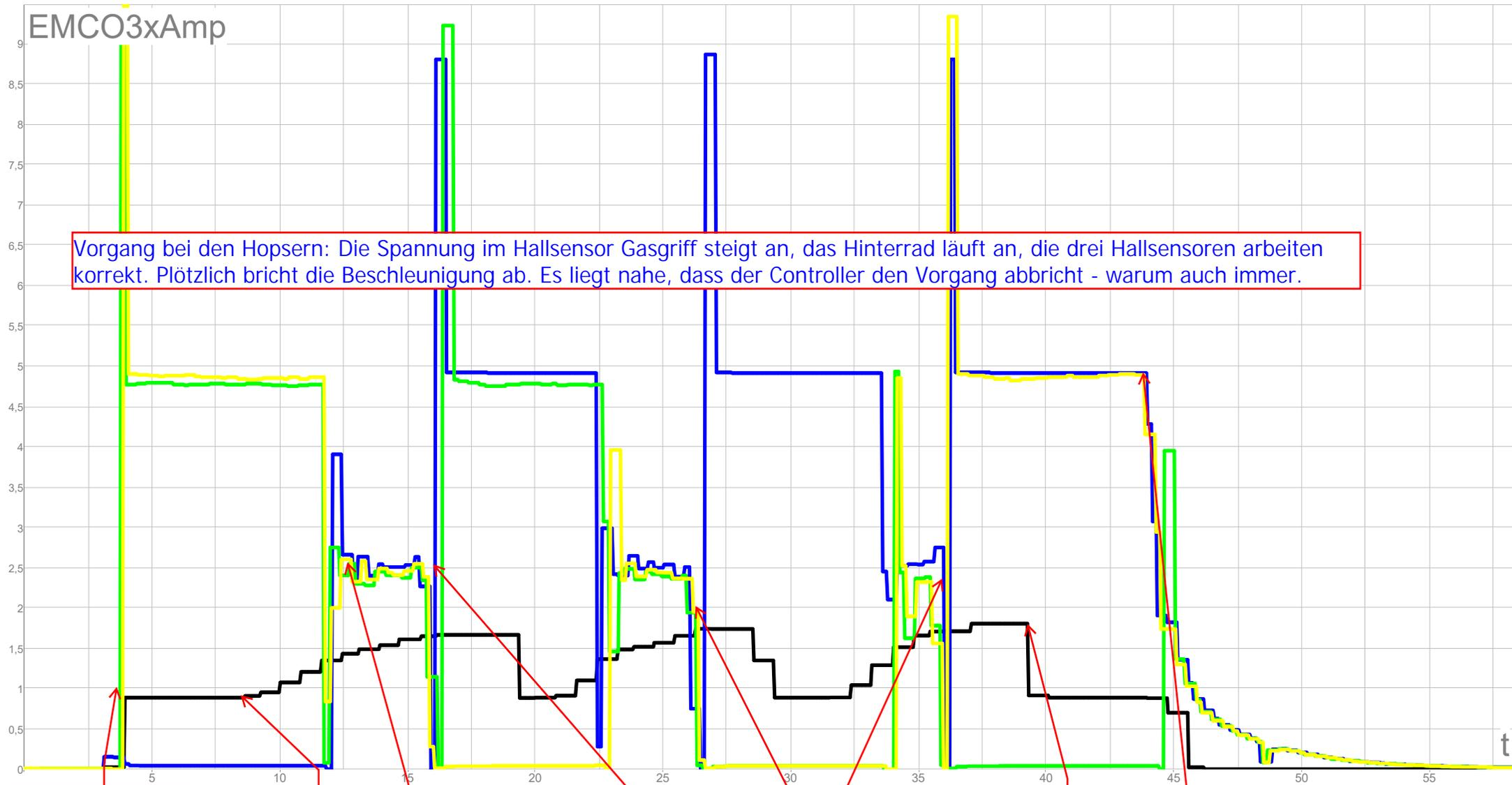
Vorgang bei den Hopsern: Die Spannung im Hallsensor Gasgriff steigt an, das Hinterrad läuft an, die drei Hallsensoren arbeiten korrekt. Plötzlich bricht die Beschleunigung ab. Es liegt nahe, dass der Controller den Vorgang abbricht - warum auch immer.
